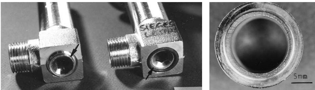
Abbildung 3: Bruchstelle im Bereich eines O-Ring-Sitzes, rechts 2. Bruchhälfte
