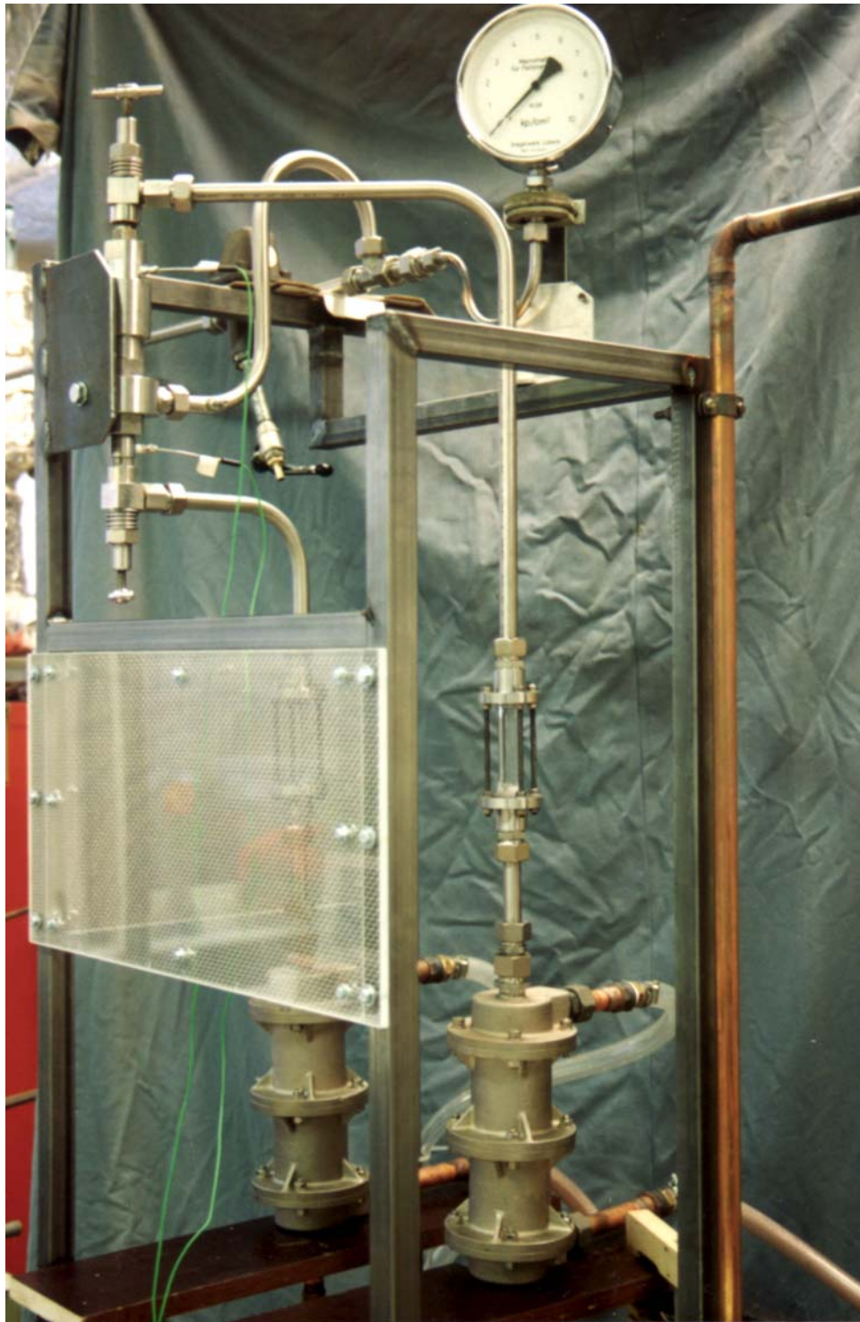
Fig. 6: Wirbelrohr zur Entspannung von Wasserdampf. Das Rohr befindet sich mit lotrechter Achse links oben im Bild. In der Bildmitte unten sind 2 mit Kaltwasser betriebene Kondensatoren sichtbar. Diese werden benötigt, um die aus dem Rohr austretenden Dampfströme zu kondensieren und durch Wägung zu bestimmen.
