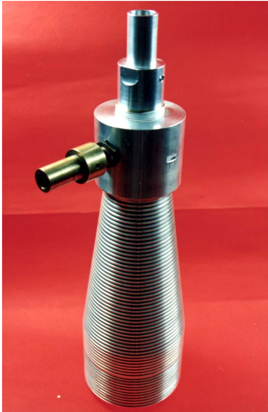
Fig. 15: Wirbelbirne zur gleichzeitigen Expansion und Kühlung technischer Gase [37].
