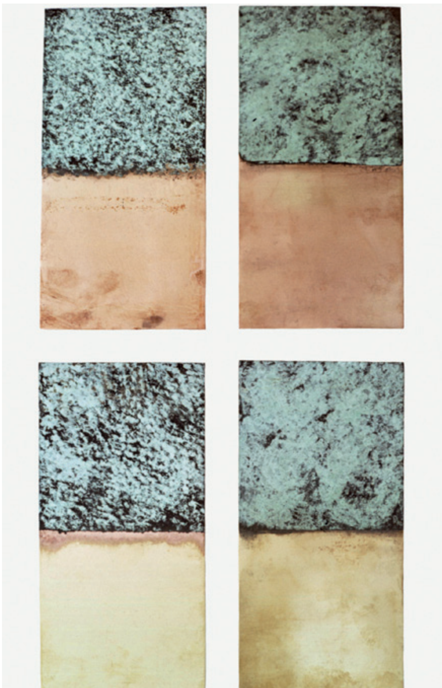
Bild 4 (DKI 4225) Nitratpatina mit schwarzem Untergrund auf Kupfer Cu-DHP (obere Reihe) und Messing CuZn37 (untere Reihe).
