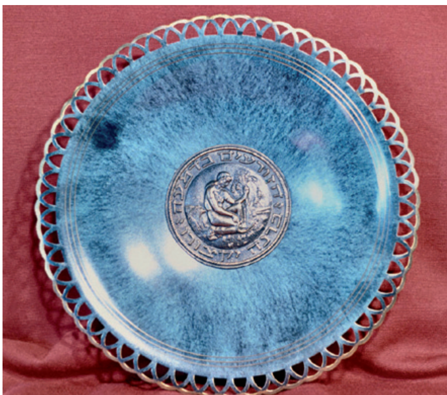
Bild 2 (DKI 4785) Spritzpatinierte Schale aus Messing, Mittelstück aus Zinkdruckguss, elektrolytisch vermessingt und braungefärbt.
