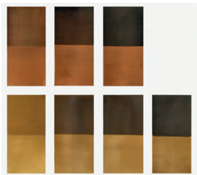
Bild 10 (DKI 4229) Schwefelleberfärbungen auf Cu-DHP (obere Reihe) und Messing CuZn37 (untere Reihe). Die unterschiedlichen Farbintensitäten auf Kupfer wurden durch unterschiedliche Tauchzeiten (1 s; 30 s; 2,5 min.) erhalten, die auf Messing CuZn37 durch mehrmaliges Tauchen und Zwischenbürsten*)
